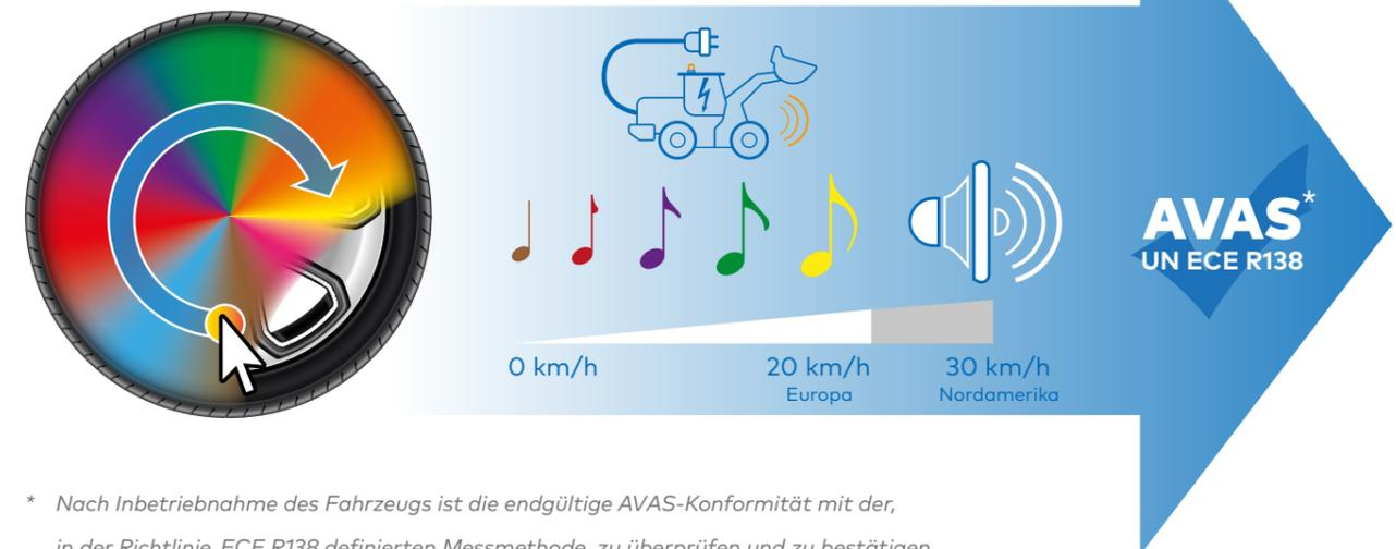
\* Nach Inbetriebnahme des Fahrzeugs ist die endgültige AVAS-Konformität mit der, in der Richtlinie ECE R138 definierten Messmethode, zu überprüfen und zu bestätigen.
